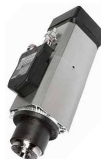
Performante e affidabile, l' elettromandrino da 6,6 kW con attacco HSK63-F, velocità di rotazione fino a 24.000 giri/min, è la soluzione ideale per eseguire fresature localizzate sulle varie tipologie di pannelli. Posizionato sulla testa superiore permette fresature cieche e passanti.
