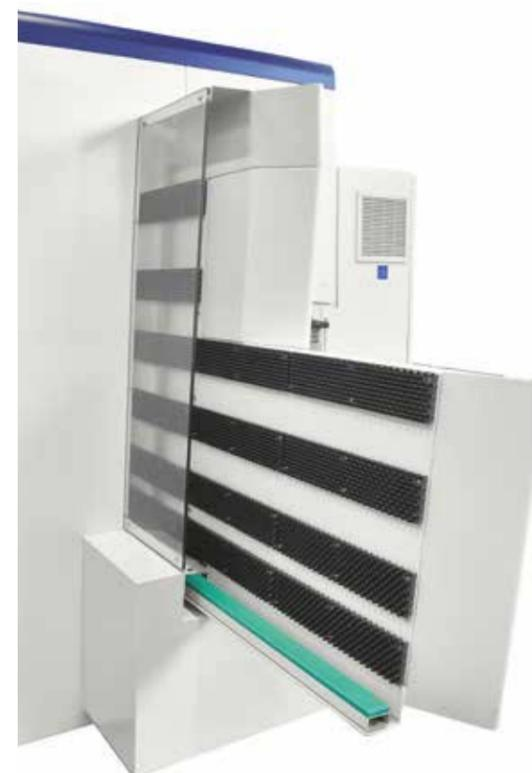
Ergonomica, i supporti laterali consentono all'operatore di caricare e scaricare con ergonomia pannelli fino a 3050 mm.
