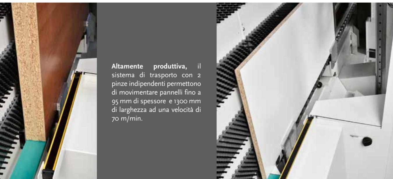
**Altamente produttiva**, il sistema di trasporto con 2 pinze indipendenti permettono di movimentare pannelli fino a 95 mm di spessore e 1300 mm di larghezza ad una velocità di 70 m/min.
