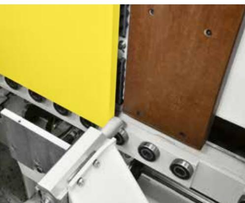
**Alto livello di versatilità**, la battuta di riferimento programmabile permette di lavorare pezzi anche con spine già inserite o con fresate già eseguite.
